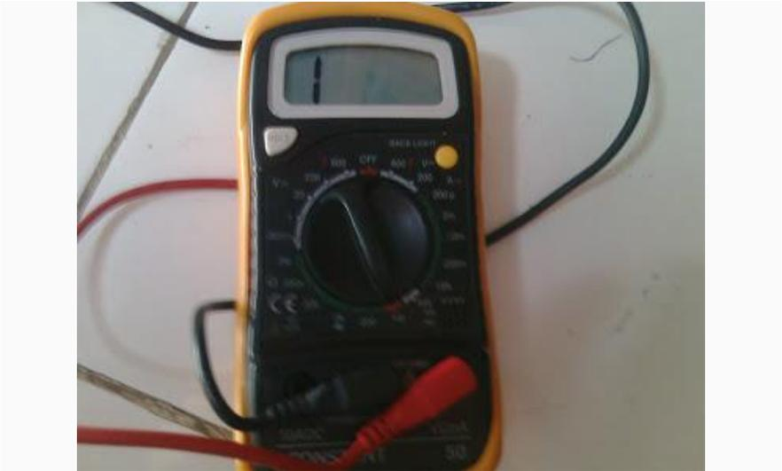
Gambar 12.5 AVO meter digital diseting untuk mengecek sambungan
