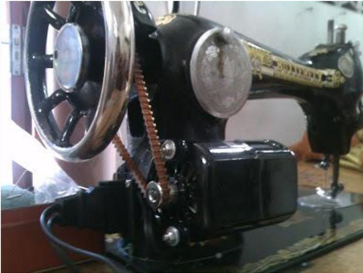
Gambar 12.1 mesin jahit yang dilengkapi motor AC
