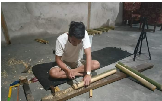
Gambar 4.17. Pembuatan lubang alat tiup (Nataniel Benyamin, Mamasa, 2022)
