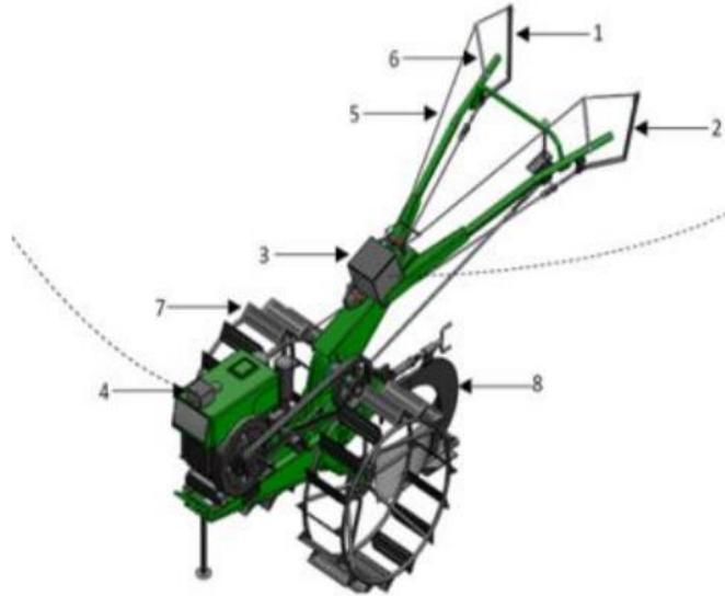
Rangka utama dalam penelitian ini berfungsi sebagai box control dan dudukan servo. Rangka utama terbagi menjadi beberapa bagian, yaitu box control, dudukan servo kopling dan dudukan servo gas. Instalasi penarik kopling berfungsi sebagai penghubung antara servo yang terdapat pada rangka utama ke kopling maupun gas. Instalasi penarik kopling terbuat dari pipa besi yang dibengkokkan dan dipasang pada handle kopling lalu dihubungkan ke servo dengan tali kopling sebagai penghubung.
