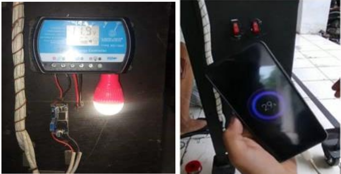
Gambar 11 Listrik DC yang Dihasilkan (Lampu DC yang Menyala dan Menisi Batere HP)
