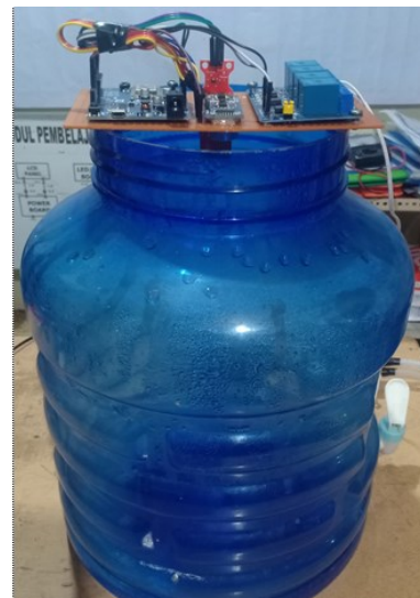
Gambar 7. Pemasangan sistem pengendalian ketinggian air menggunakan aplikasi IoT pada penampungan air
