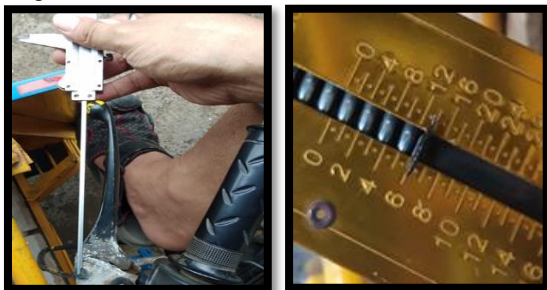
Gambar 4. 1. Pengukuran Gaya Tekan Pada Tuas Rem
