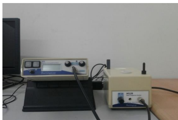
Gambar 2. Magnetic Susceptibilitymeter type MS2 (Lab. Geofisika dan Teknik Pertambangan Fakultas Ilmu Teknologi dan Kebumian Universitas Halu Oleo).
