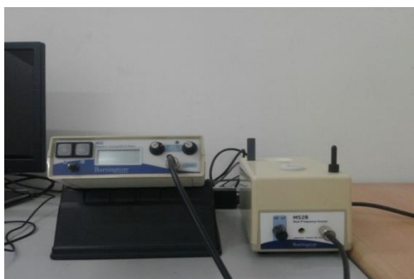
Gambar 2. Magnetic Susceptibilitymeter type MS2 (Lab. Geofisika dan Teknik Pertambangan Fakultas Ilmu Teknologi dan Kebumihan Universitas Halu Oleo).
