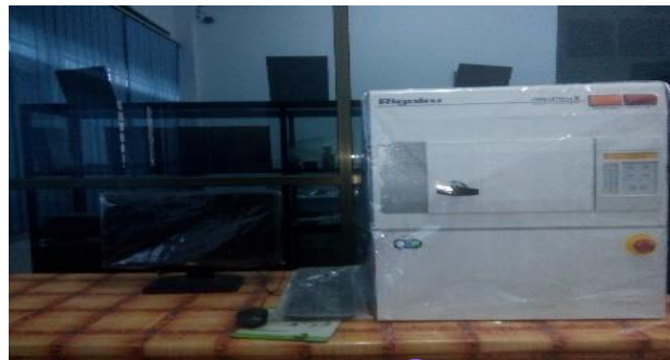
Gambar 3. XRD Rigaku MiniFlex II, Lab. Mikrostruktur Jurusan Fisika Fakultas Matematika dan Ilmu Pengetahuan Alam UNM
