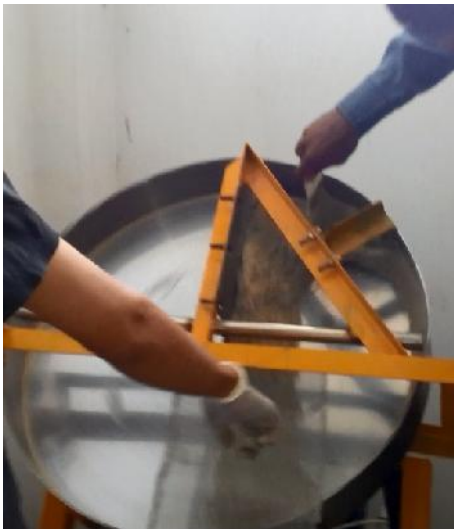
Gambar 1. Proses pembuatan pupuk granulasi di pan granulator
