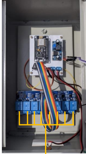
8 Slot Relay Untuk Menghidupkan Lampu Secara Otomatis
