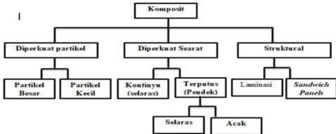
Gambar 1: Struktur Penyusunan Komposit (Sabarudin,2019)
