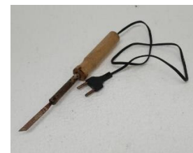
Gambar 4. solder untuk membuat ornamen lamming (Dokumentasi: Agung Wirawan, 2022).
