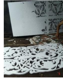
Gambar 4.22 Pemotongan menggunakan solder (Dokumentasi: Agung Wirawan, 2022).
