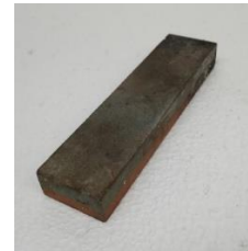
Gambar 8. Batu Asah untuk mempertajam mata cutter
