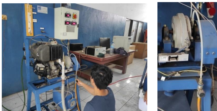
Gambar 3. Proses pembebanan mesin diesel
