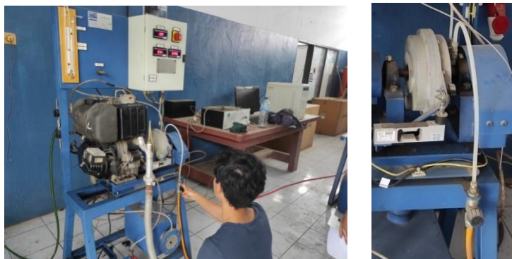
Gambar 3. Proses pembebanan mesin diesel
