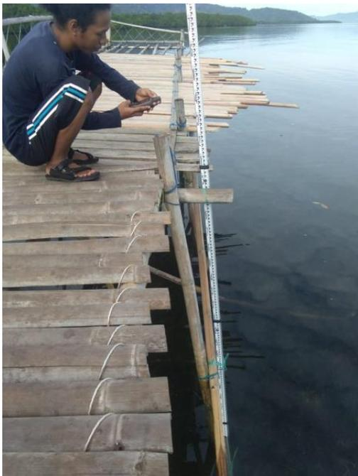
Gambar 5. Pengukuran pasang surut air laut (Sumber: hasil survei lapangan, 2018)
