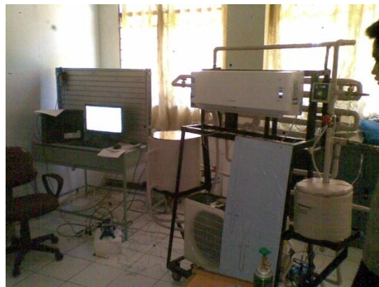
Gambar 2. Pengujian VCO sebagai bahan thermal storage
