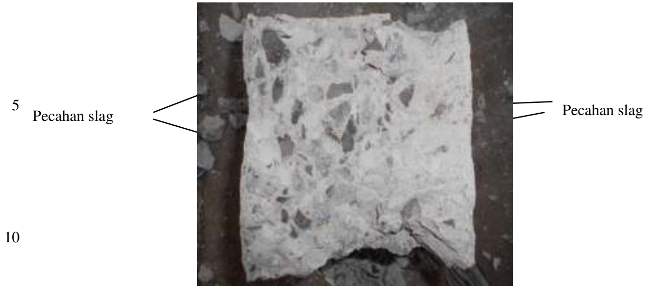
Gambar 2. Semen beton Portland setelah uji tekan
