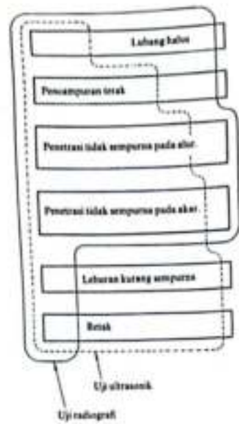
Gambar 2.22 Diagram pengujian ultrasonik dan radiografi berdasarkan bentuk cacat pada pengelasan (Harsono dan Okumura, 2000)
