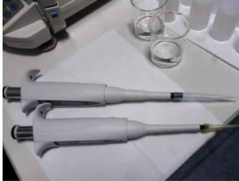
Gambar 6. 27. Mikropipet
