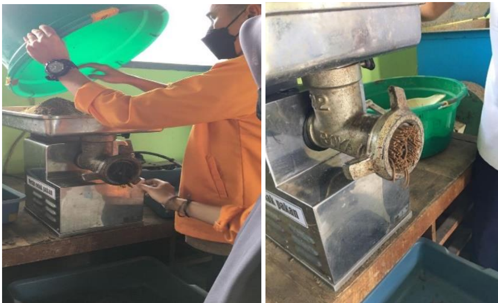
Gambar 4.9 Proses pencetakan pakan (Sumber : BRPBAPPP Maros)
