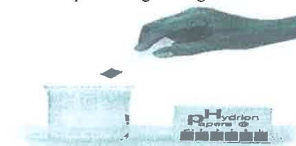
Gambar 6. Pengujian larutan dg ind.Universal
