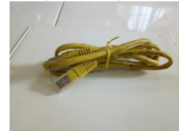
Gambar 3. Kabel UTP dan Konektor RJ45
