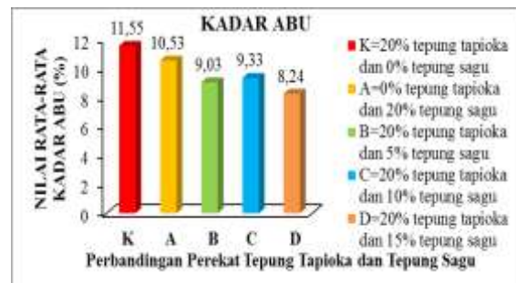
Gambar 2 Analisis kadar abu pada briket bioarang kulit buah nipah dengan perbandingan tepung tapioka dan tepung sagu.
