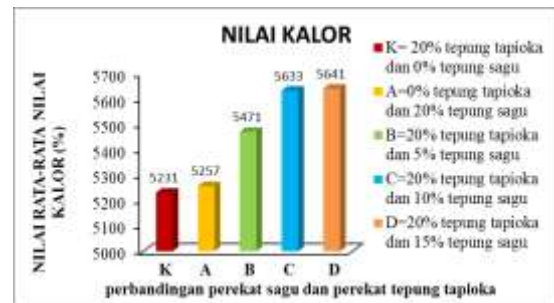
Gambar 5 Analisis nilai kalor pada briket arang kulit buah nipah dengan perbandingan tepung tapioka dan tepung sagu.
