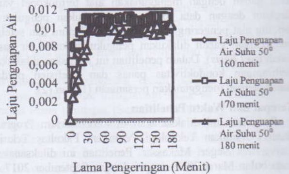
Gambar 3. Laju penguapan air gabah selama dalam pengeringan pada berbagai variasi suhu dan lama pengeringan
