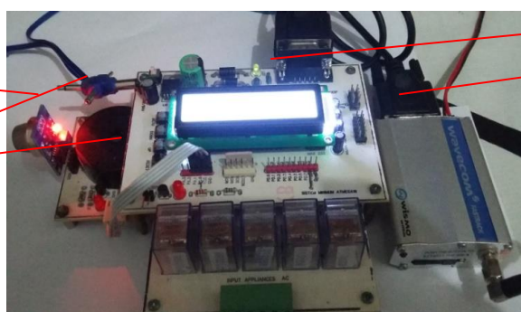
Gambar 8. Bagian – bagian Pengendali Home Appliances
